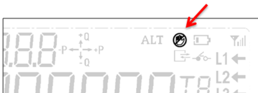
Рисунок 17 – Отображение включения режима программно-аппаратной блокировки переключения реле
