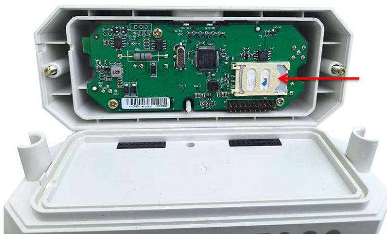
Рисунок 22 – Установка SIM-карты в слот БВПД модели ЭС-770-13-G счетчика исполнения «С»
