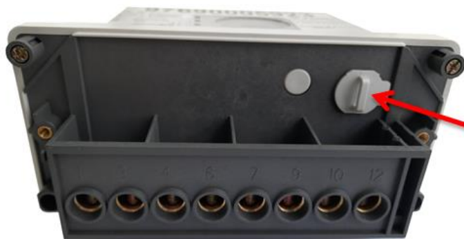
Рисунок 26 – Место установки дополнительной батареи RTC в счетчике исполнения «С»
