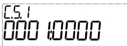
Рисунок 38 - Нарушение качества ЭЭ по напряжению
