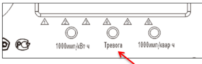
Рисунок 29 – Индикация тревоги на корпусе счетчика
