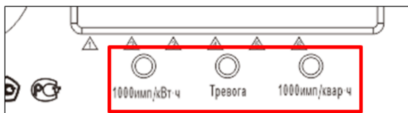
Рисунок 14 – Общий вид индикаторов состояния счетчика исполнения «Х»
