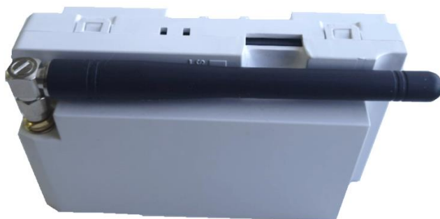
Рисунок 20 – БВПД GPRS модели ЭС-770-12-G счетчика исполнения «Х»
