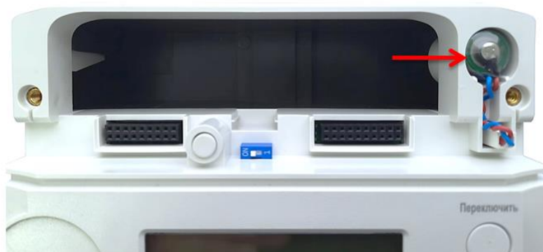
Рисунок 25 – Место установки дополнительной батареи RTC в счетчике исполнения «Х»
