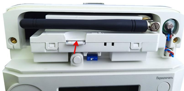
Рисунок 21 – Установка SIM-карты в слот БВПД модели ЭС-770-12-G счетчика исполнения «Х»
