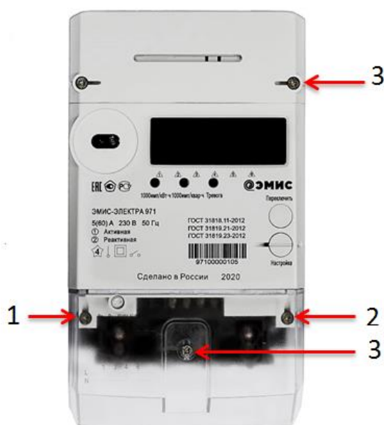
Рисунок 62. Места установки контрольных пломб счетчика исполнения «Х»
