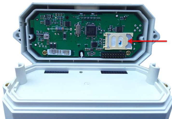
Рисунок 148 - Установка SIM-карты в слот БВПД счетчика исполнения «С»
