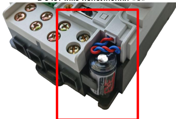
Рисунок 19 - Место установки дополнительной батареи RTC в счетчике исполнения «С»
