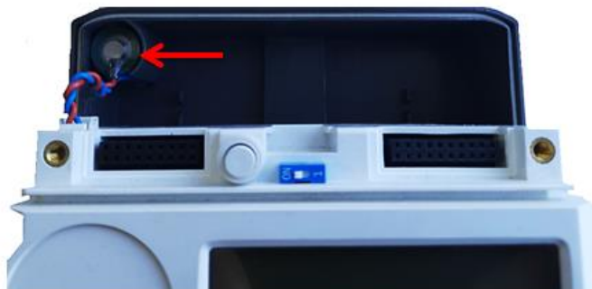
Рисунок 18 - Место установки дополнительной батареи RTC в счетчике исполнения «Х»
