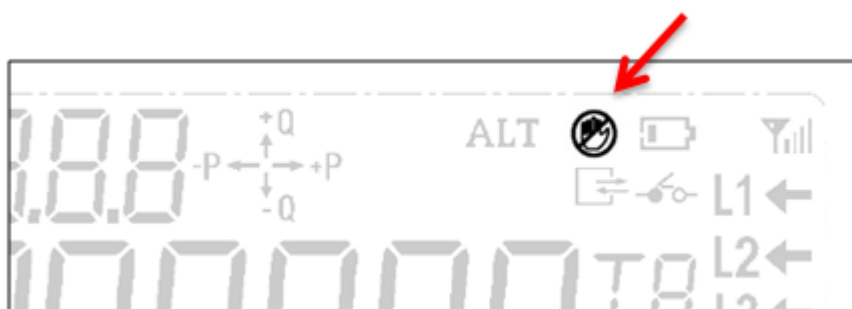
Рисунок 6 – Отображение включения режима программно-аппаратной блокировки переключения реле
