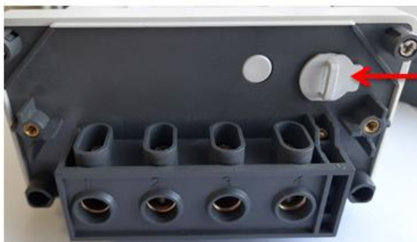
Рисунок 19 - Место установки дополнительной батареи RTC в счетчике исполнения «С»
