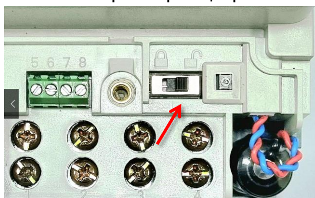
Рисунок 17 - Переключатель аппаратной фиксации реле счетчика исполнения «ХК»
