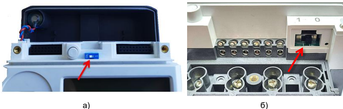
Рисунок 16 - Переключатель аппаратной фиксации реле счетчика исполнения «Х»
