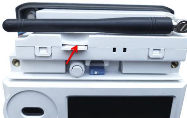
Рисунок 12 - Установка SIM-карты в слот БВПД счетчика исполнения «Х»
