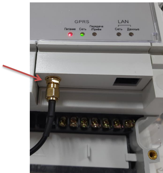
Рисунок 7 - Подключение антенны GSM к БВПД
