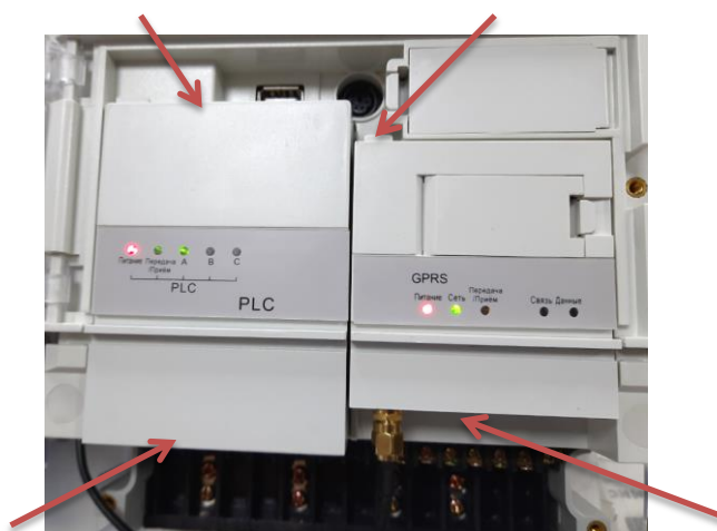
Рисунок 5 - Отсек БВПД концентратора со снятой крышкой зажимов
